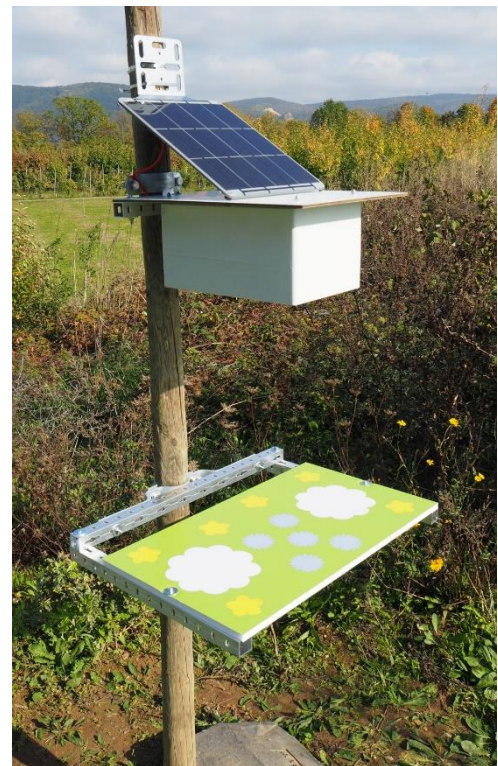
Abb. 80 Solarbetriebene Kamerafalle zum kontinuierlichen automatisierten Monitoring von blütenbesuchenden Insekten. (© M. Sittinger, JKI).
