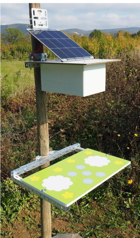
**ABB 3: Kamerafalle zum automatisierten Insektenmonitoring.** Insekten werden durch die Blütenplattform angelockt und nach Landung von der KI-Software erkannt und aufgenommen.
